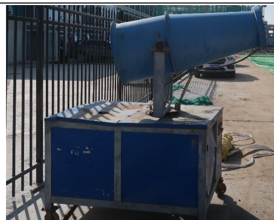
洒水降尘装置（2022.7）
