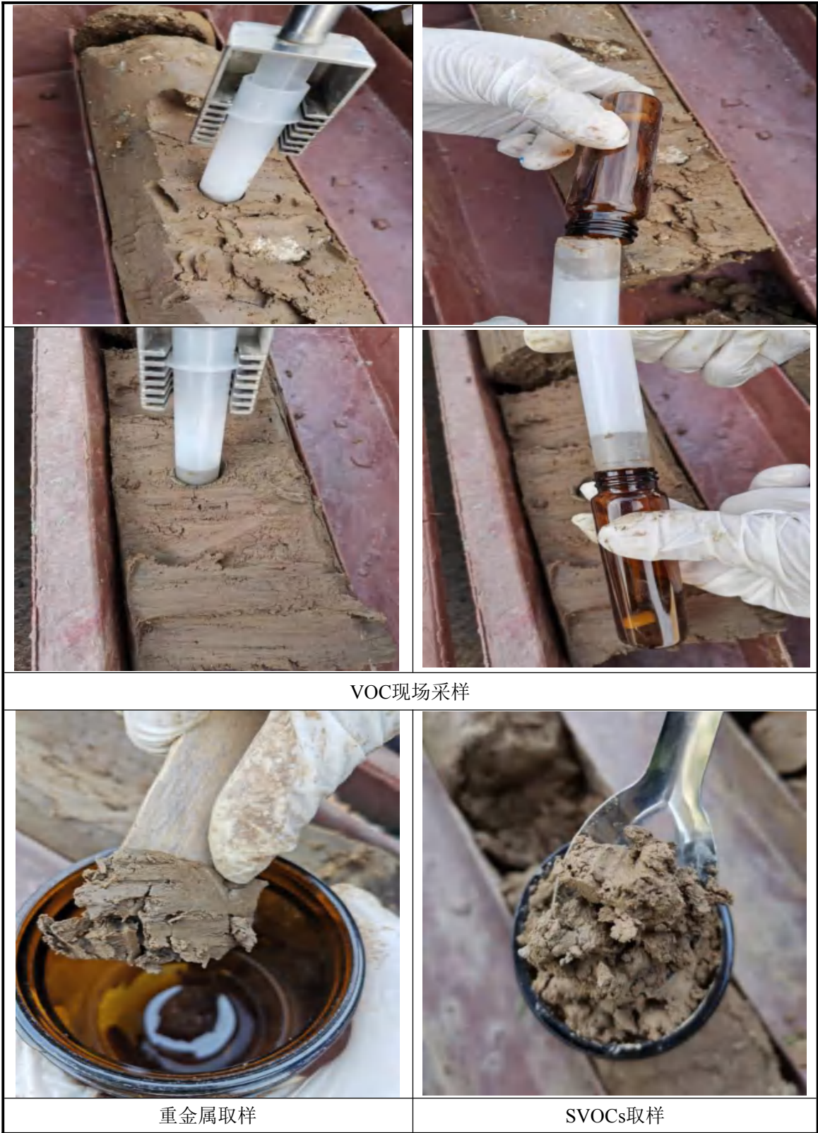
图 4.2-5 现场取样照片
