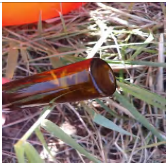
VOCs 样品采集（顶空无气泡）
