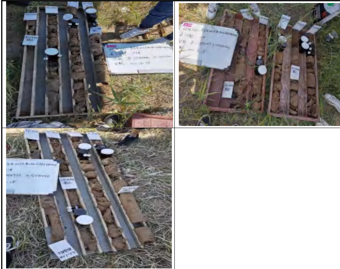
图 4.2-6 岩芯箱摆放照片
