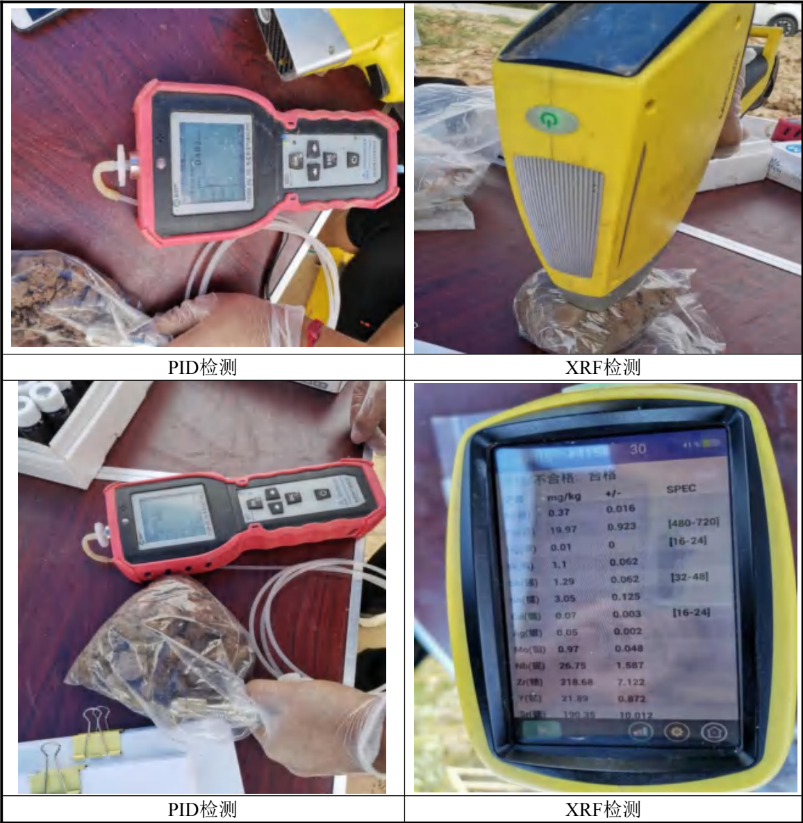
图 4.2-4 现场快检及取样照片
