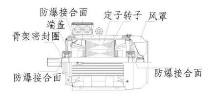
图 1 电动机主体结构
