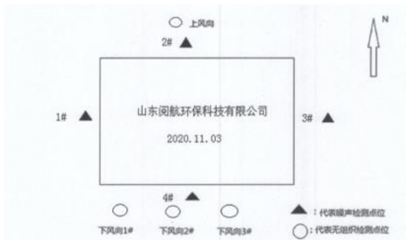
图 7-1 噪声检测布点示意图
