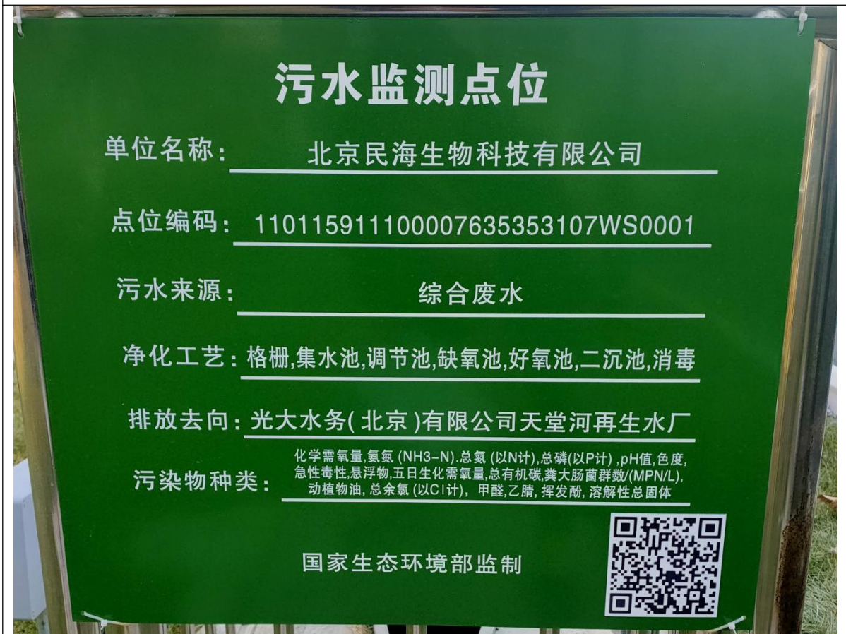
废水排放口监测点位标识牌
