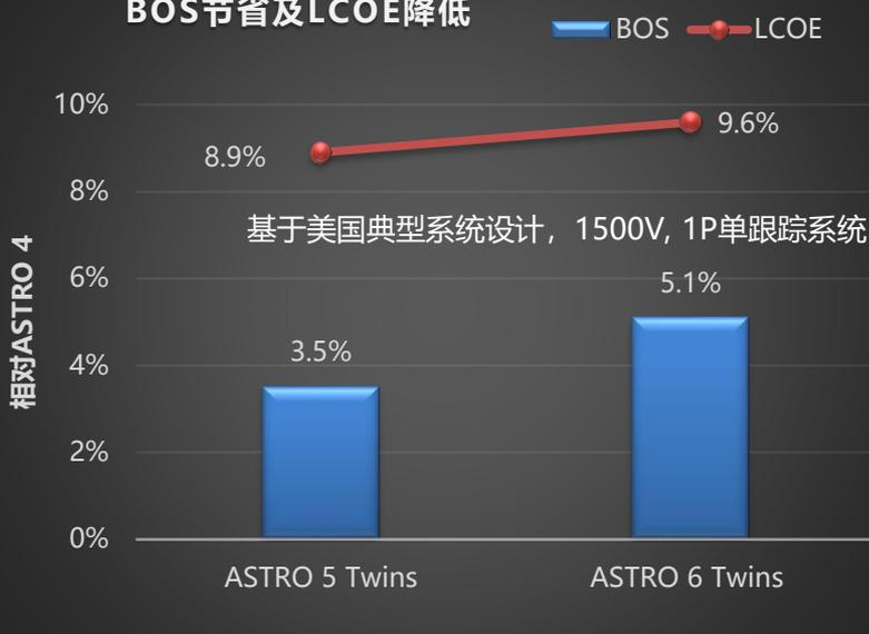
● ASTRO 6 “高功率+低电压” 使单组串功率比ASTRO 4提高64%，BOS成本降低5.1%，LCOE降低9.6%
