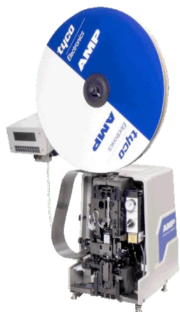
安装CQM的压接机
