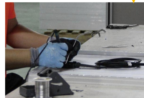
接线盒安装 (人工)
