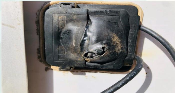
压块松动、接地不良、电缆破损、接线盒鼓包等
