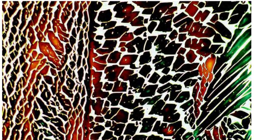
2205 双相焊缝金属的金相组织，500 ×（来源：Lincoln Smitweld bv）
