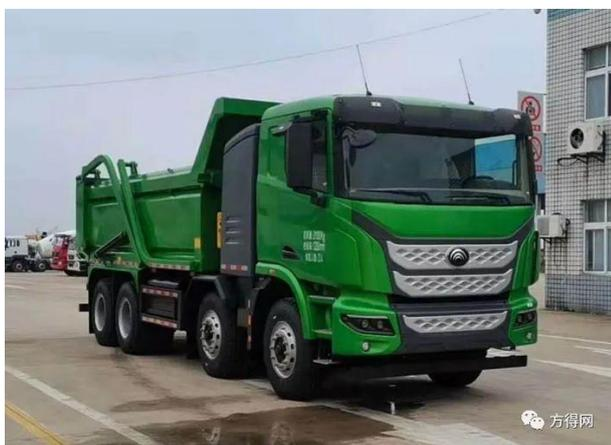
匹配宇通 450kW 电机的纯电自卸车 ZKH3310P6BEV31
