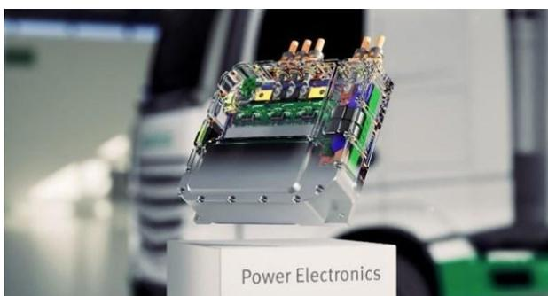
电驱动系统要实现功能并实现最大效率，还需要电机控制器。舍弗勒正在开发满足商用车应用需求的电机控制器
