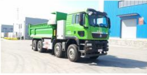
ZJX5310ZLJDZ701BEV 纯电动自卸式垃圾车
