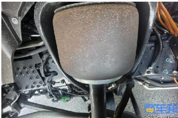
前桥采用气囊悬架，可以根据路况和速度调节车身高度
