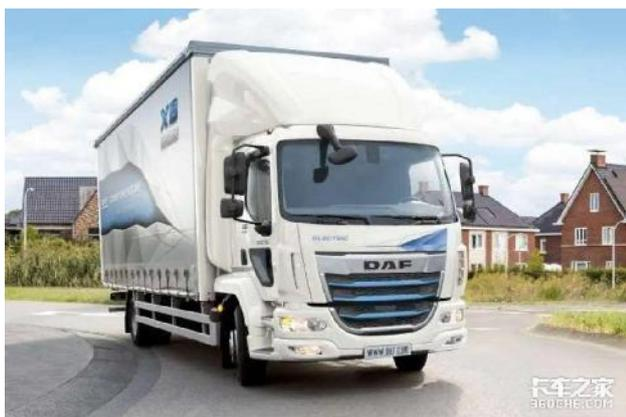
吨到 19 吨的多个吨位，其中电动版本更是令人瞩目，拥有 12、15 和 19 吨的不同吨位。XB Electric 卡车的续航里程达到了 350 公里，这让其配送半径得到了扩大。并且 XB Electric 可以在短短 40-70 分钟内从 20% 充到 80%，让车辆可以快速投入到运输工作中去。
