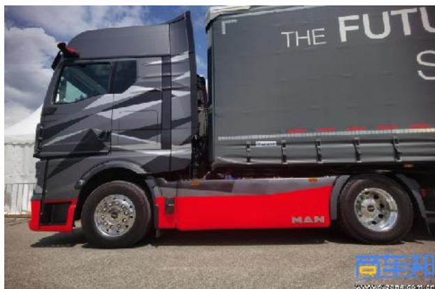
商用车的工具属性要求货厢尺寸最大化，在整车长度限定的情况下，MAN eTruck 采用传统的平头驾驶室，达到了货厢尺寸极限，在驾驶室容积、舒适性等方面要超
