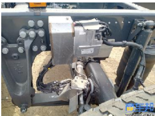
斯堪尼亚 5 轴底盘后承载桥的主动转向系统
