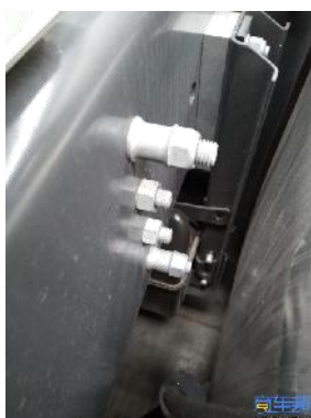
斯堪尼亚重卡车架根据连接力需求采用不同螺栓
