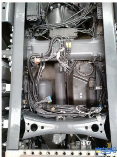
斯堪尼亚重卡的两种横梁：钢板冲压横梁，铸造横梁
