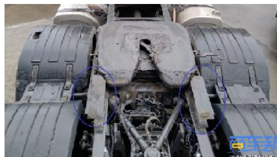
图 4 某牵引车安装的限位板，防止车架后端与半挂车发生磕碰
