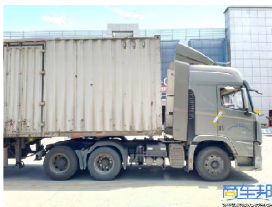
图 3 某快递快运车型为了降低风阻，将鞍座前移
