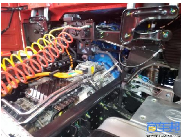
远程星瀚 H 超醇电混合动力总成由甲醇发动机+电动机+变速箱组成
