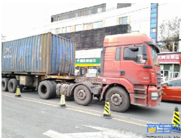
图 7 6X2 牵引车鞍座到后桥中心距离比 4X2 要增大
