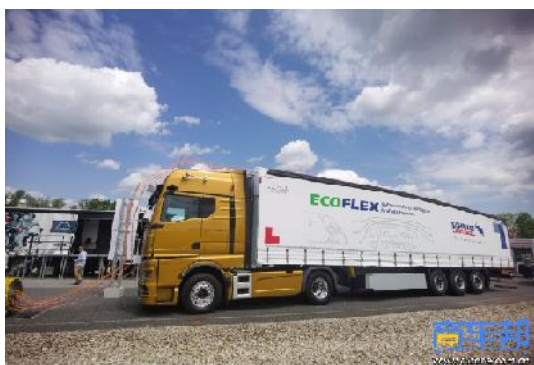
图 2 MAN TGX 的主挂空气动力学一体化设计
