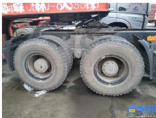
图 6 某大件运输车的鞍座增加了垫板
