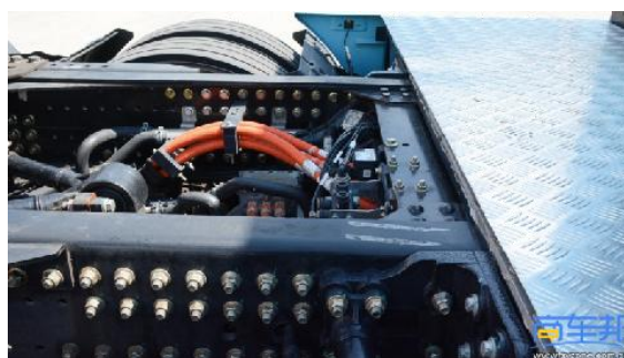
三一 1165 三段式车架的连接位置
