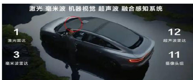
华为自研 192 线激光雷达，可实现全车幅、超远距、超敏捷，250 米以外精准识别。
