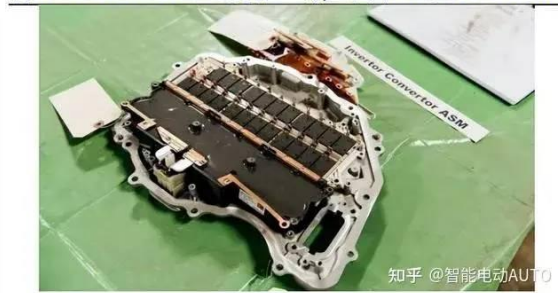
图5: Tesla Model 3 逆变器结构，采用 24 块 ST T-PAK
