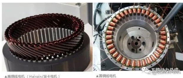
▲扁铜线电机（Hairpin/发卡电机）
