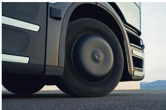
另外据梅赛德斯奔驰官方透露，这套全新的外观设计，更低的风阻系数可以带来 3% 的燃料节省，这倒是一个很重要的升级，而且 Actros L 还拥有官方空气套件，包括低滚阻的轮胎和降低风阻的轮毂盖。
