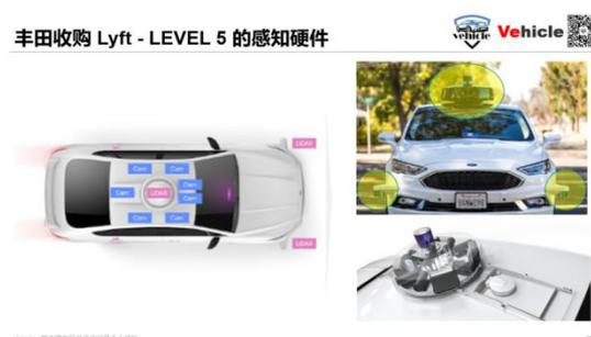
图：Level IV-Autonomy 1.0 感知硬件配置
