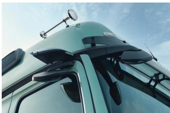
新车依旧提供电子后视镜和传统后视镜选择，作为业内最早量产车采用电子后视镜的厂商，奔驰的电子后视镜还是业内领先的，各项功能都考虑到实际使用，体验还是非常不错的。而在主被动安全方面迭代的 ABA6、ASGA2、ADA3 这些也会出现在新车上，相信安全性、智能驾驶等方面会有明显提升。
