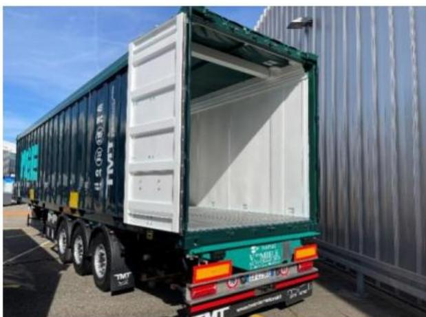
活动地板由驱动单元、地板条、耐磨块、油泵、油箱、液压管路构成，动力由半挂牵引车取力器外接油泵提供。
