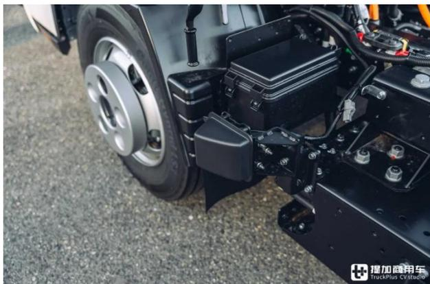
三菱扶桑 Canter 系列轻卡不仅在日本生产，同时还在葡萄牙等海外工厂生产，专供当地市场使用。针对欧盟 GSR 通用安全条例的相关限制，改款三菱扶桑 Canter 增加了众多传感器，实现多样的主动安全功能。例如：在前轮后方，车辆增添了侧面盲点雷达，覆盖侧后方视野，检测这一盲区之内的潜在障碍物。
