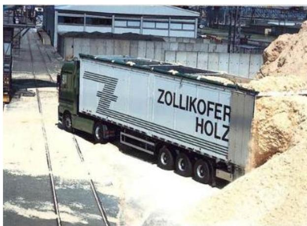
(3) 卸料安全性：自卸式半挂车因采用厢体侧翻或后翻的方式卸料，所以在卸料作业时必须有足够防倾翻功能和规范操作流程，当侧翻卸料时，厢体下方有防倾翻支腿，必须先打开放倾翻支腿，再操作卸料，当后翻卸料时，必须将车辆停在相对水平的地面，若停在侧向有坡度的地面，则会出现后翻举升过程中车辆侧翻的可能。
