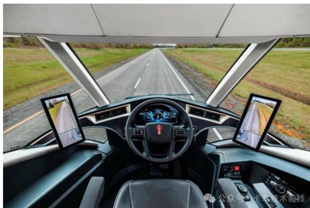
与 SuperTruck 2 项目中的其他项目一样，Kenworth 完全取消了物理反射镜，物理后视镜被摄像头和提供夜视功能的驾驶室内显示器所取代，进一步将阻力降至最低。集成数字后视镜系统能够增强后视镜监控，具有挂车跟踪功能和
