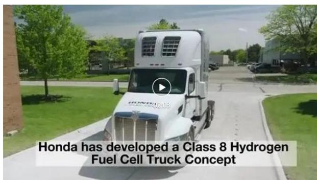
正在运行的本田 Class 8 卡车概念由三个新的本田燃料电池（FC）系统提供动力，目前在燃料电池系统制造有限责任公司（FCSM）进行批量生产，该公司是与通用汽车（GM）位于密歇根州布朗斯敦的合资生产工厂。新的燃料电池系统是本田氢业务战略的关键。本田 FC 系统由本田和通用汽车在过去十年中共同开发，与上一代 1 系统相比，本田 FC 系统提
