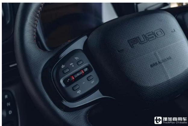
在内饰方面，改款三菱扶桑 Canter 轻卡同样做出了升级。多功能方向盘上带有多种多功能按键，驾驶员可方便的操控车辆功能，例如定速巡航、接打电话等等。同时，驾驶员也可借助多功能方向盘来控制全液晶仪表盘及新增的多媒体屏幕，提供智能互联功能。
