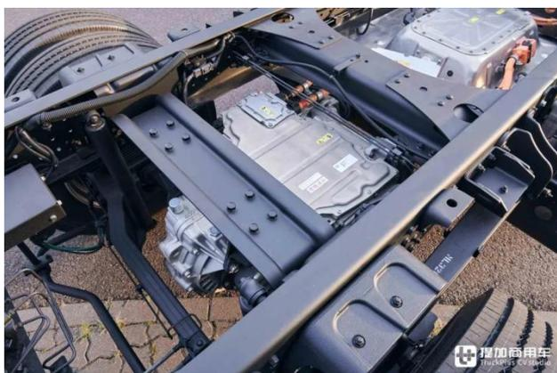
根据车辆轴距不同，三菱扶桑 eCanter 提供三种不同的电池配置，容量分别为 41.3kWh、82.6kWh 及 123.9kWh。同时，三菱扶桑 eCanter 采用了 e-Axle 集成式电驱桥，具备 110kW、129kW 两个版本。
