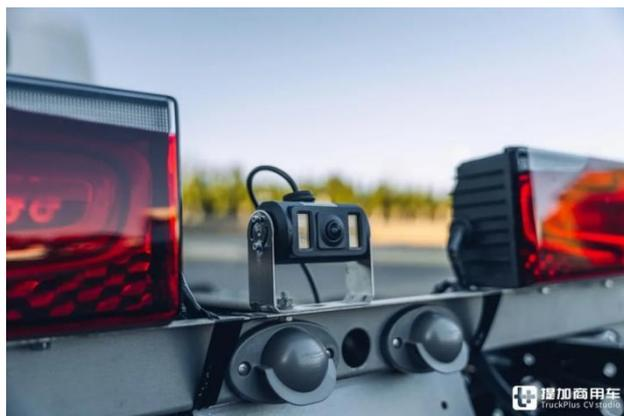
车架尾端同样增添有摄像头，用作倒车摄像头，提供车辆后方面面
