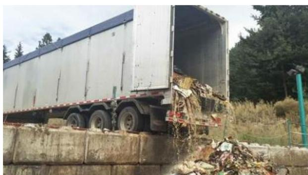
(1) 装料优势：自卸式半挂车一般通过装料设备从货箱顶部上料，对作业的高度方向留有足够空间；该型半挂车可具备顶部开启和侧边翼开式，根据装料设备采用顶部装料或侧边装料，顶部装料时对作业的高度方向留有足够空间，侧边装料时对作业的宽度方向留有足够空间，且侧部装料时，需要装料设备依次从前到后将厢体装满，对装料操作人员的技术要求较高。
