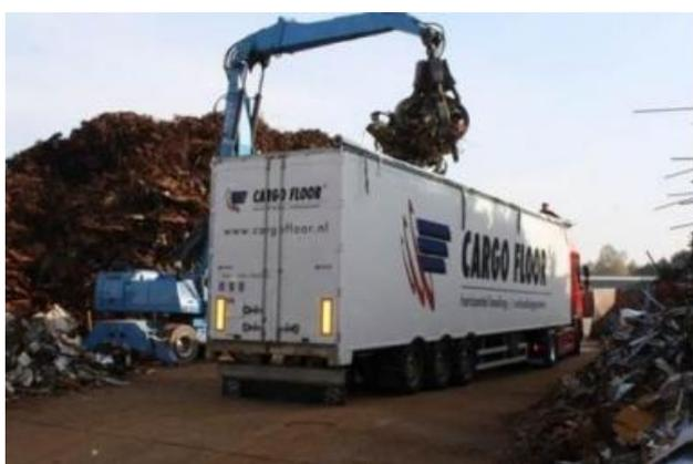
平移式自装卸厢式半挂车车厢体尺寸大，长度 12 米，宽 2.5 米，高 3 米，净容积可达 92m<sup>3</sup>，配备有顶盖和后门，可根据货物大小、状态、属性来选择顶部装料或装料，具有水平自装卸功能，厢体
