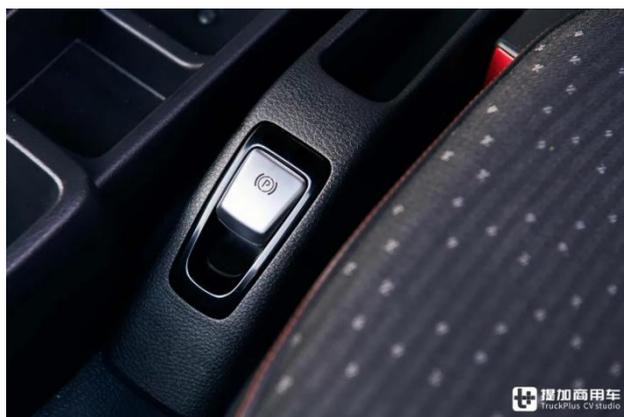
电子手刹与自动驻车搭配，避免忘拉手刹而导致的溜车等问题
