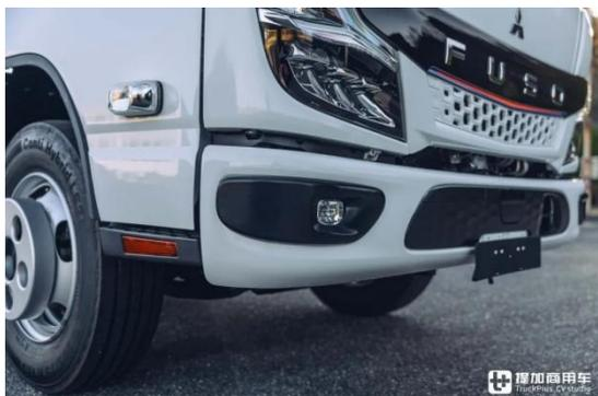
虽然保险杠采用了一体式结构，但在外观上仍塑造出了左-中-右的三段式视觉。在圆润的线条内部，集成有车辆雾灯、前部毫米波雷达等配置，其余空位采用凹凸花纹饰板填满，塑造视觉整体性。
