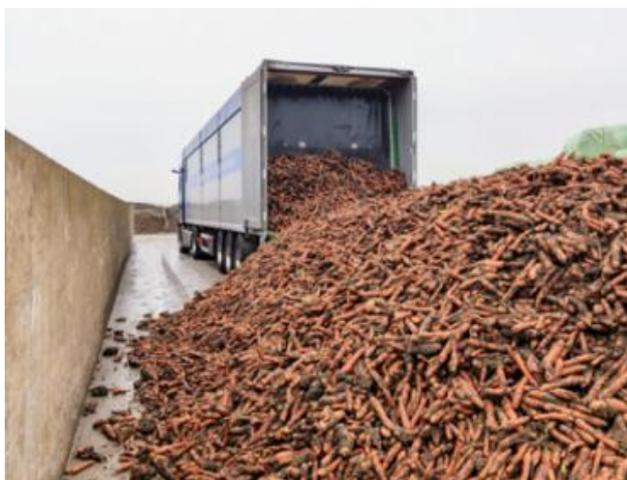
活动地板式自装卸厢式半挂车顶部有顶盖，后部有后门，配备活动地板，可根据货物大小、状态、属性来选择顶部装料或后部装料，
