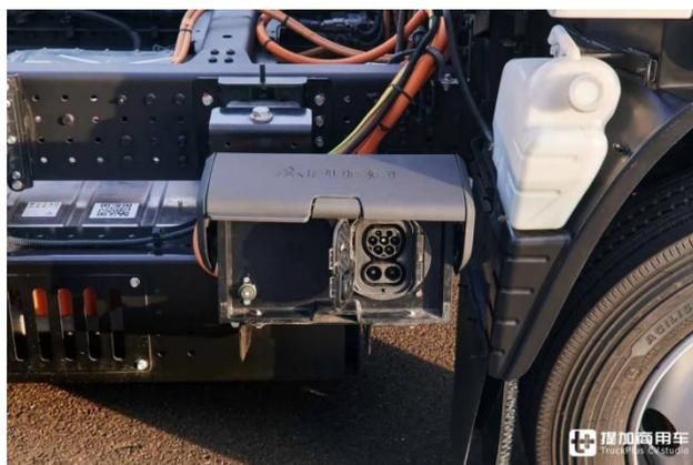
三菱扶桑 eCanter 搭载 CCS Type-2 组合快充接口，直流快充功率最大可达 104kW
