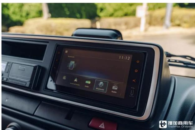
在仪表台中部，是车辆全新的 6.95 英寸触摸多媒体屏幕，它将收音机、导航、DAB+无线电接收等多种功能集成在了其中。此外，这块屏幕支持苹果 Carplay 及安卓 Auto 互联，使用更便利。
