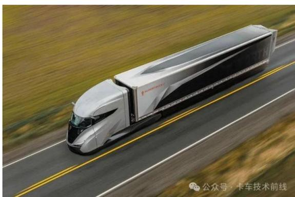
作为与能源部超级卡车项目合作的一部分，该卡车历时 6 年开发，旨在挑战卡车制造商使用柴油发动机作为主要动力源来提高货运效率。项目目标是与 2009 年的 Kenworth T660 相比，货运效率提高 100%，最终实现效率提高 136%；
