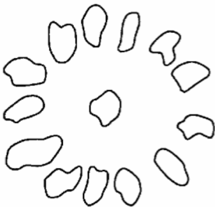
图 2 典型的喷油器喷雾图形
