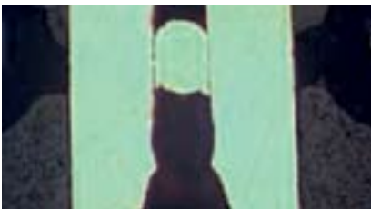
带状电缆AWG-26横截面 实心电线90°电缆出口
