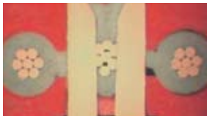
带状电缆AWG-26横截面 绞合电线180°电缆出口
