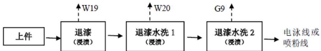
图 2.7 退漆返工生产线工艺流程及产污环节示意图
