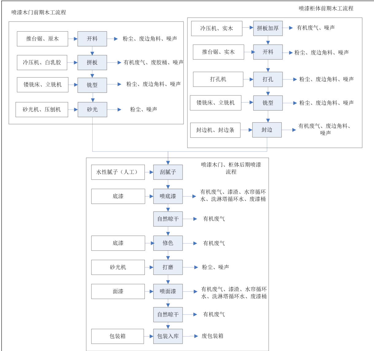
图 2-2 喷漆家具生产工艺流程及产污位置图
