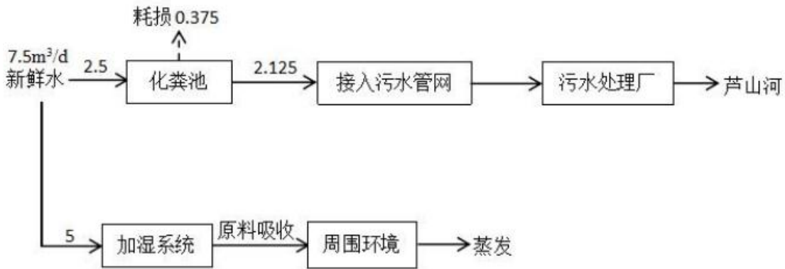
附图 2-3 项目水平衡图 单位：m 3 /d
