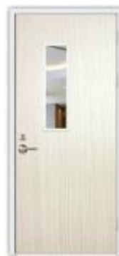
钢木质防火门 (门框为镀锌钢材、面板为免漆板、门扇骨架为阻燃木材、填充材料为防火芯板)
