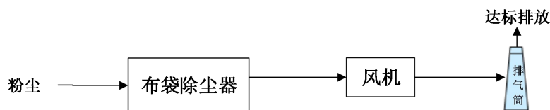
图 2-4 粉尘废气处理系统示意图
