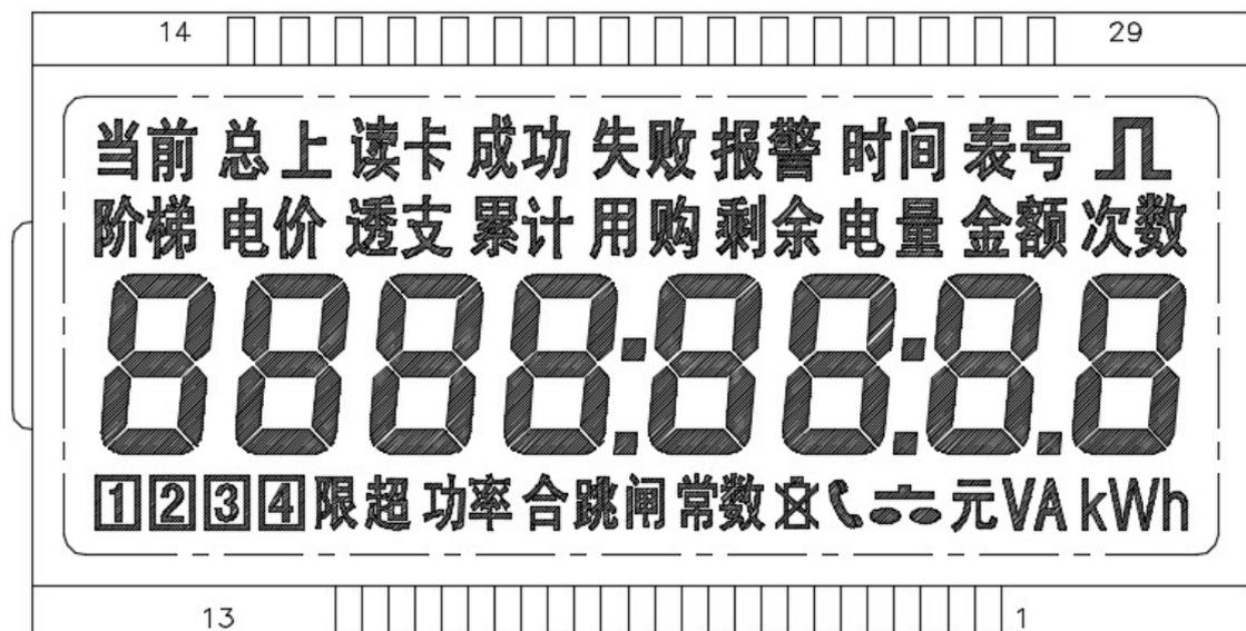
预付费电能表显示剩余电量采用倒计时方式工作，最小显示递减单位为  $0.01kWh$ 。当剩余电量为  $0 kWh$  时电表断电一次，用户插入用电卡后可继续用电。递减为负值显示，以提醒用户需要输入新的购电量。当负值达到一定值时（出厂前可设定，一般为  $-10kWh$ ）则自动断电，输入新的购电量后恢复供电。当剩余电量小于报警值时，剩余电量闪烁显示。
