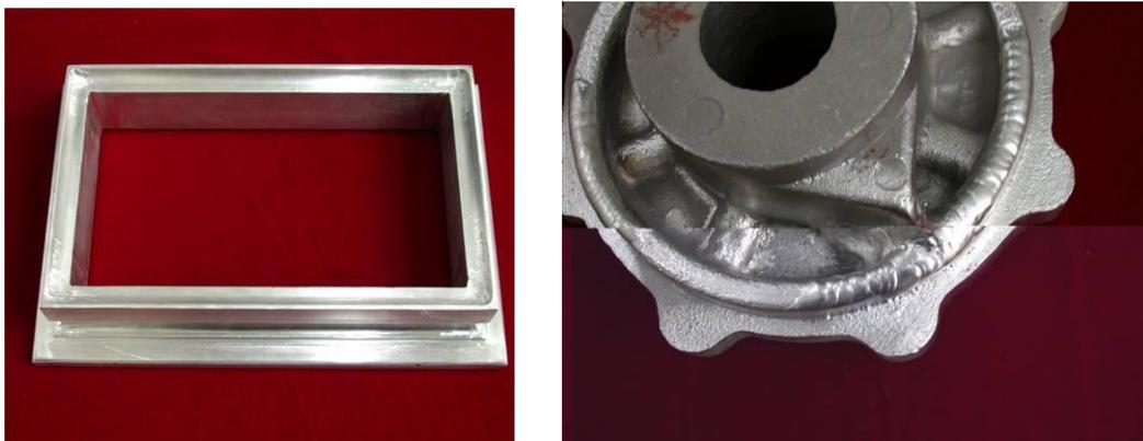
飞机发动机镁合金构件焊接及修补照片
