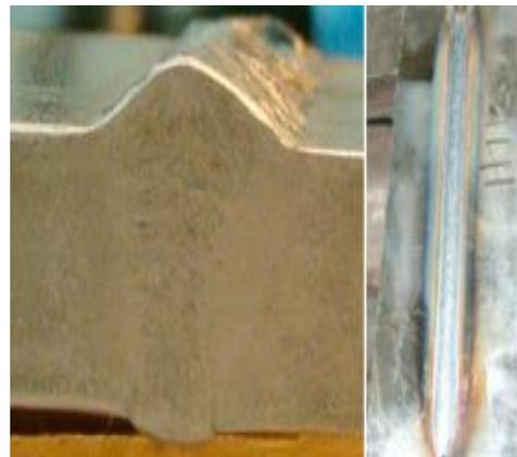
等离子-MIG 焊接 10 毫米低碳钢板
