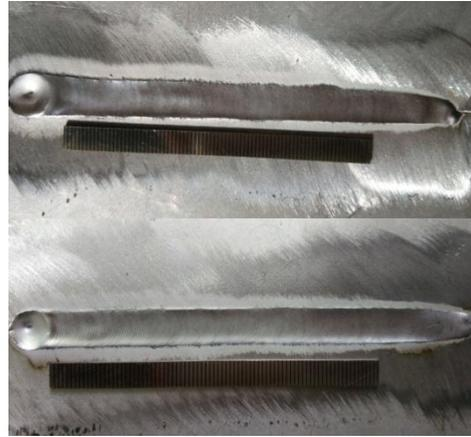
5A06 铝合金钨极自转 TIG0 转(上)和 10000 转焊缝成型
