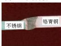
铜/钢电子束自熔钎焊
