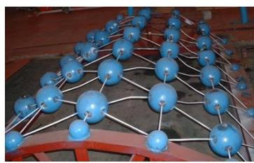
单层柱壳地震模拟振动台实验
