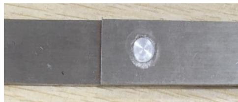
图 6 铝材搭接焊点
