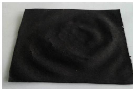
图 2 制备的可导电防水透气膜
