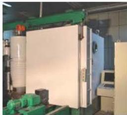
自主集成真空电子束焊机（扩展真空激光焊、送丝功能）
