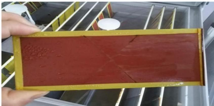
图 1.石墨烯防腐涂料(中性盐雾 700h 仍无明显锈斑)
