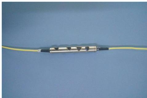
图 1 高灵敏光纤液体浓度传感探头样品照片
