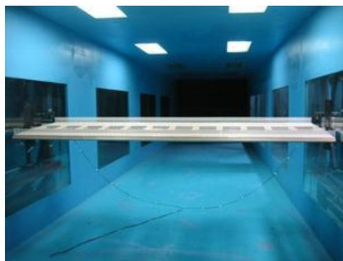
图 2 青岛海湾桥节段风洞试验
