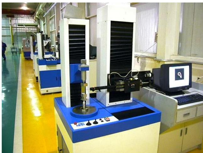
该型测量仪测量软件基于 Windows 系统开发，主要包括工件定位模块、坐标采集模块、误差分析模块、手控等模块。
