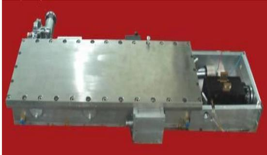
双通道电光调 Q 射频波导 CO<sub>2</sub> 激光器
