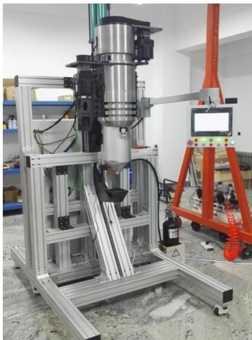
图 1 第一代回填式搅拌摩擦点焊装备原型机
