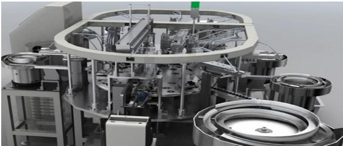
电源开关柔性生产线样机
