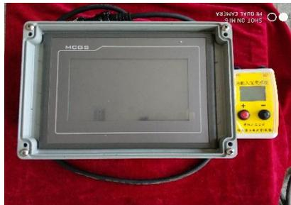
手工焊接热输入采集仪
