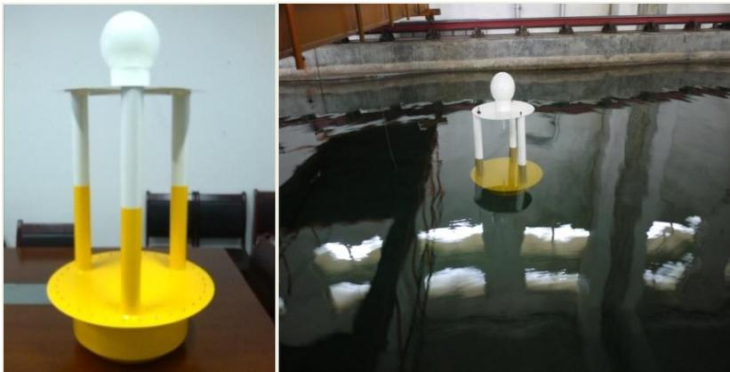
整体模型图拖曳水池试验图
