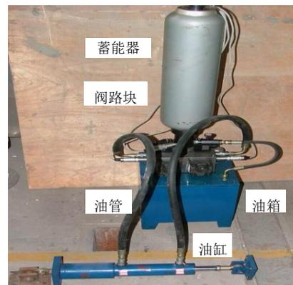
隔震换能储能装置示意——用于混合控制
