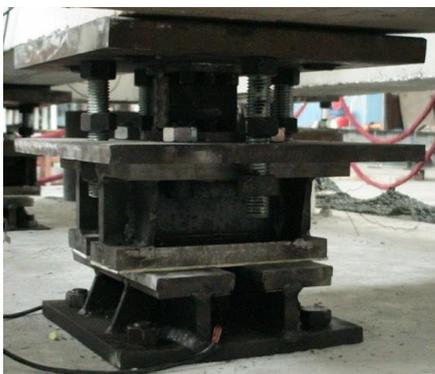
可耗能的抗倾覆装置示意图——用于高层隔震
