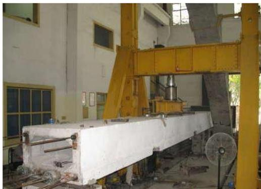
图 6 FRP 筋混凝土柱试验研究
