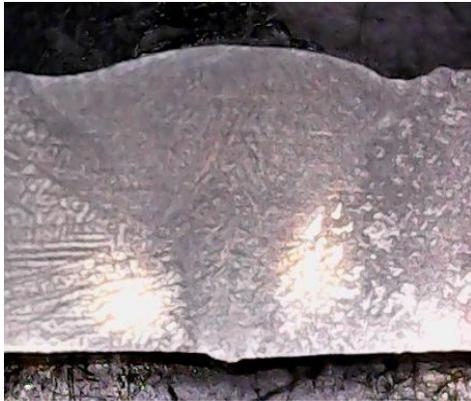
8mm 厚船用低碳钢 DTK-TIG 焊接焊缝截面
