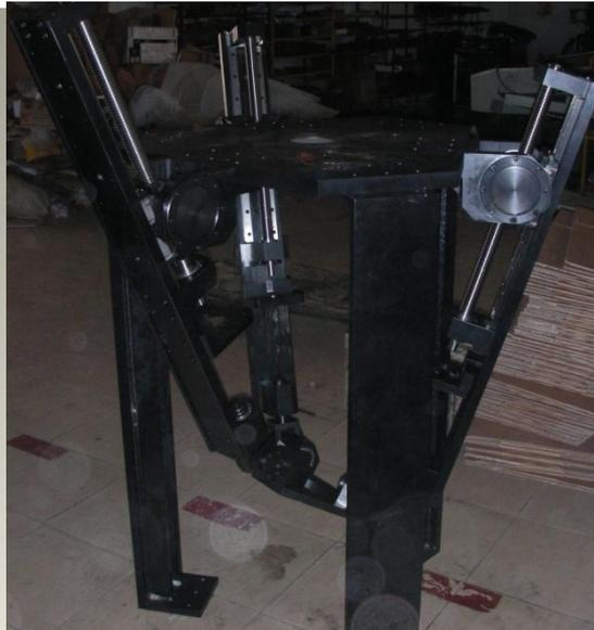
图 2 装夹机构实物图(电机未安装)
