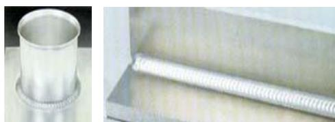
图 1 采用变极性 TIG 焊的焊接试件
