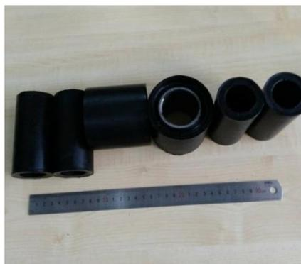
图 2. 石墨烯/弹性体复合胶辊（内衬钢套组合）
