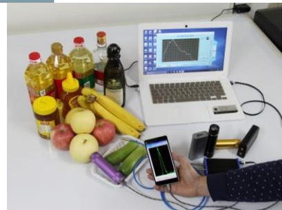
将光谱仪与手机连接，打开光谱汇 APP 进行光谱信息数据获取，普通消费者可在任意时段进行实时在线快速检测，并且将检测物品光谱数据上传至服务器。通过这种方式，将单个光谱仪作为整个光谱信息网络的原始数据采集终端从而构建光谱大数据云平台。用户将检测的光谱上传至云平台后，云平台将此光谱与数据库中的数据进行对比，并将对比结果回传至用户手机，用户可以从云平台获得对应物品的实验室标准数据或者其他用户分享的采集数据进行直观的数据比对，从而评判该产品的原材料、真实性等属性。甚至，用户还可以基于光谱网络大数据平台建立自己的数据库。平台拟优先基于位置（LBS）筛选样本库数据作为对比参照，利用大数据进行区域市场分析和基于位置（LBS）的产品推广、商品热度排行及预测、用户等级评价机制、社交平台分享、App 统计功能等。
