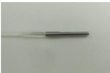
光谱随温度变化图 1 高灵敏光纤温度传感探头样品
