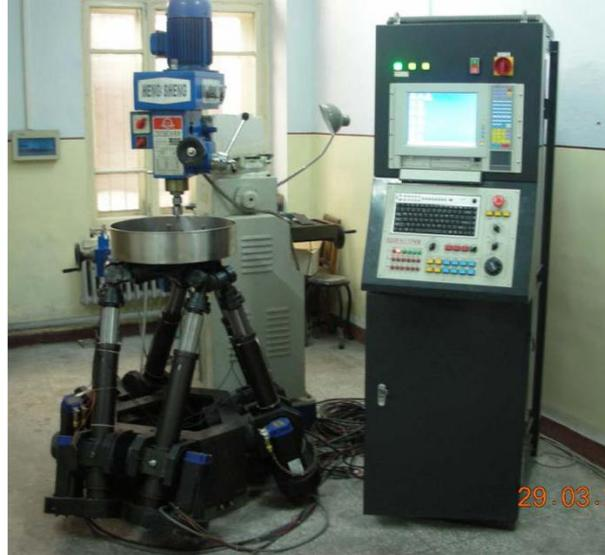
该型铣床，数控系统基于 Windows 系统开发，采用组件技术，分别提供手控模块、定位模块、刀位文件处理模块、运动执行模块、过程监控等模块。
