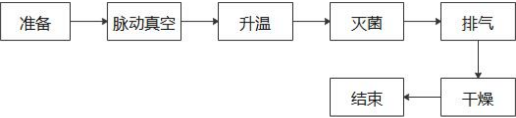
图 2.4-3 灭菌处理流程图
