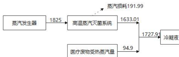
图 2.4-2 拟建项目蒸汽平衡图 (m³/a)
