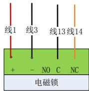
注：如果电磁锁给出的有锁信号的话，接线参考线13和线14
