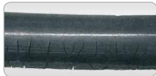
化学腐蚀对O型圈的影响
