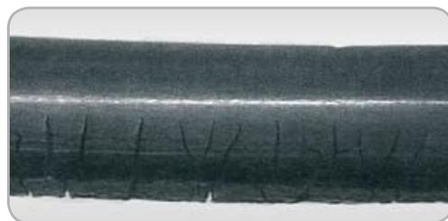
化学腐蚀对O型圈的影响
