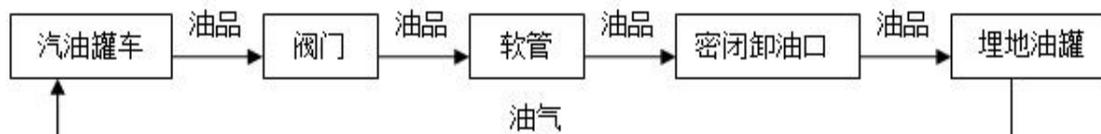
(2) 接卸柴油工艺流程框图：
