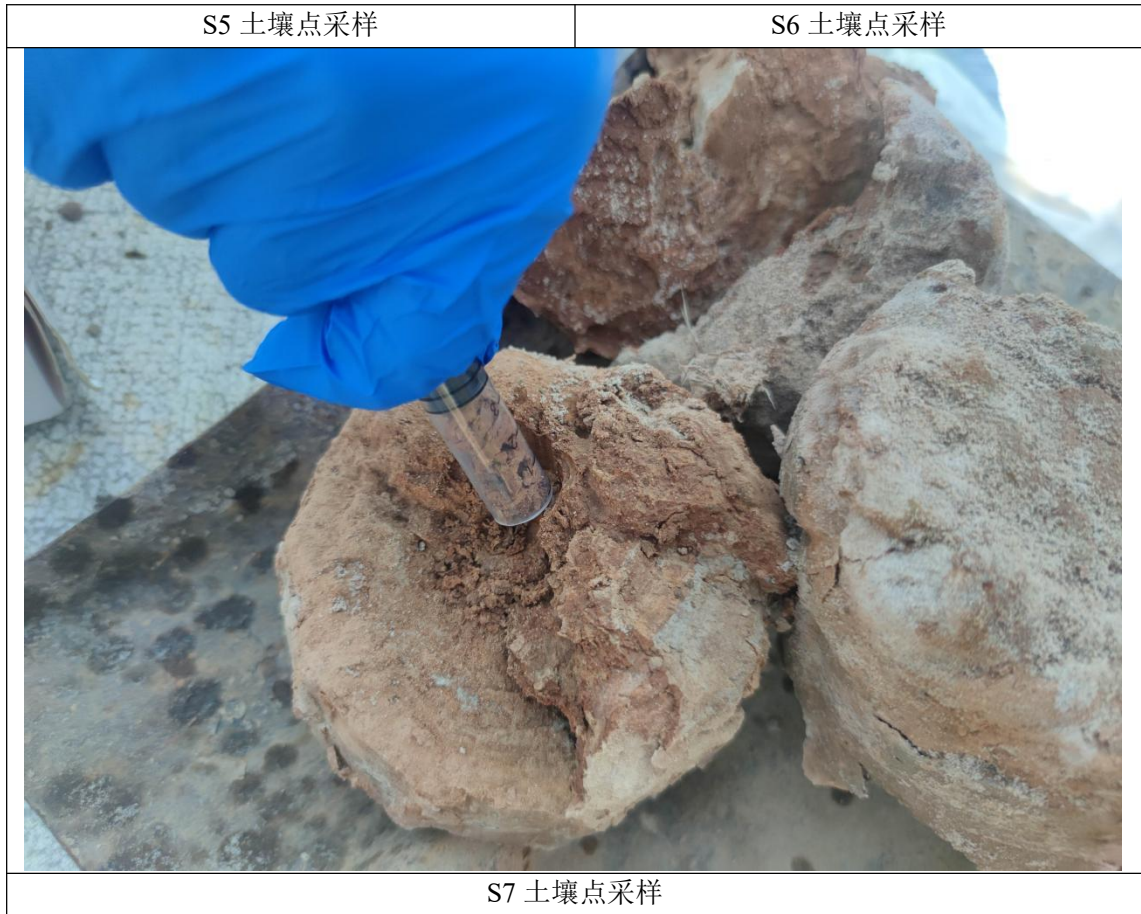
图 6.1-1 现场钻探取土照片
