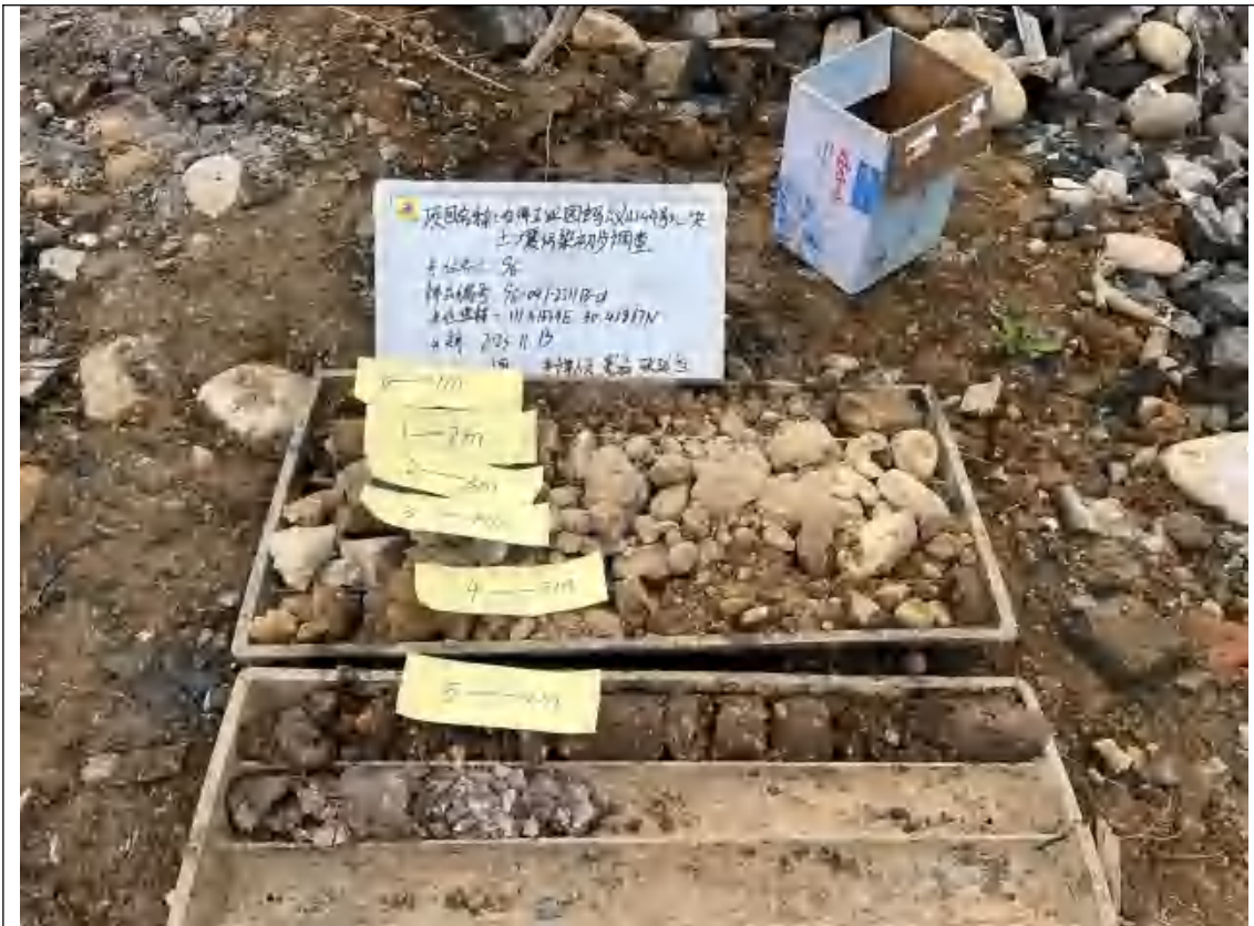
S6 实际土孔钻探深度 (6m)
