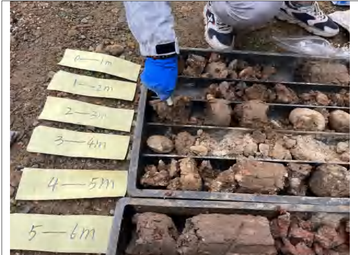
S5 实际土孔钻探深度 (6m)
