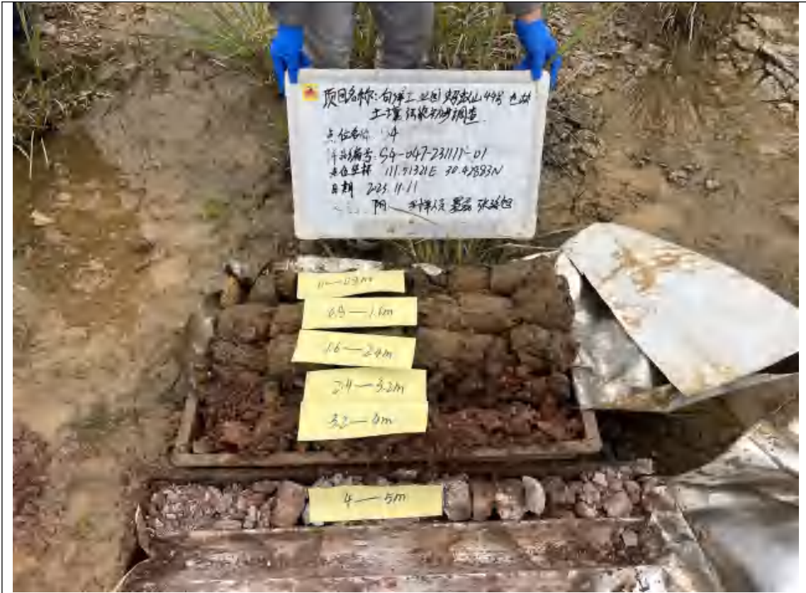
S4 实际土孔钻探深度 (4m)
