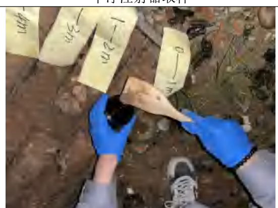
土壤样品 SVOCs 取样
