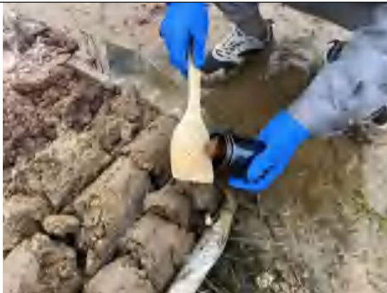
土壤样品 SVOCs 取样
