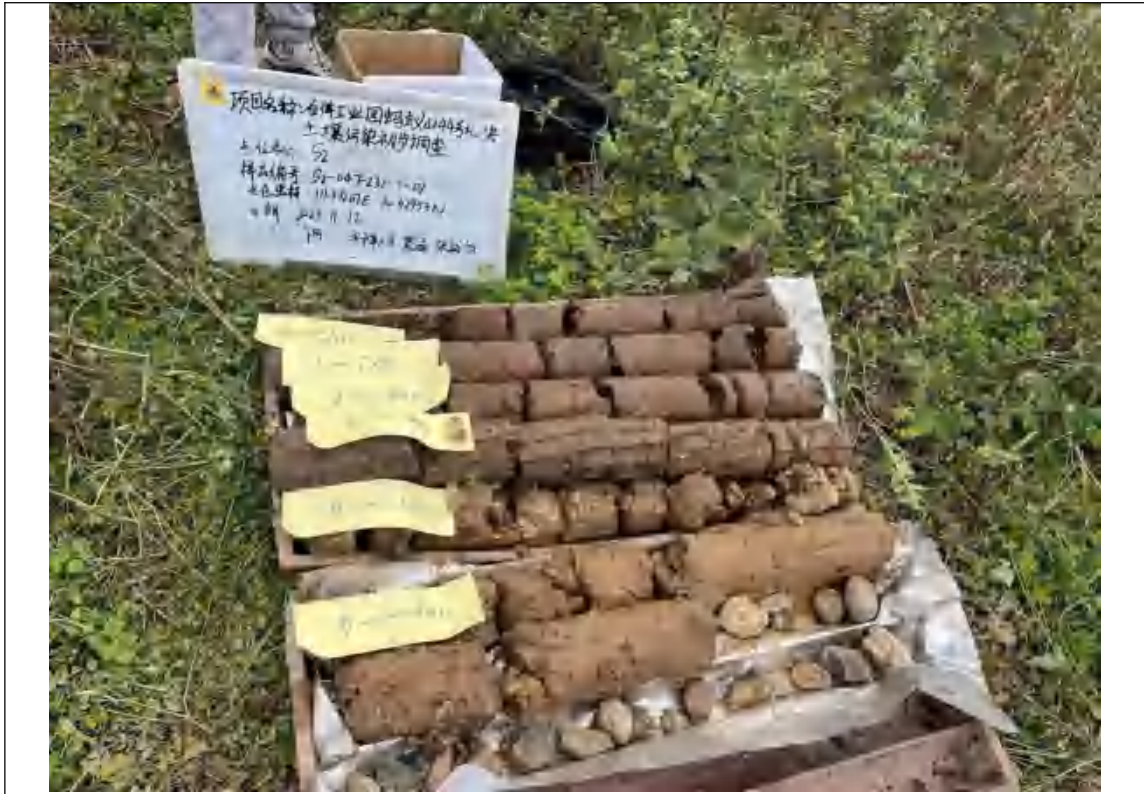
S2 实际土孔钻探深度 (6m)
