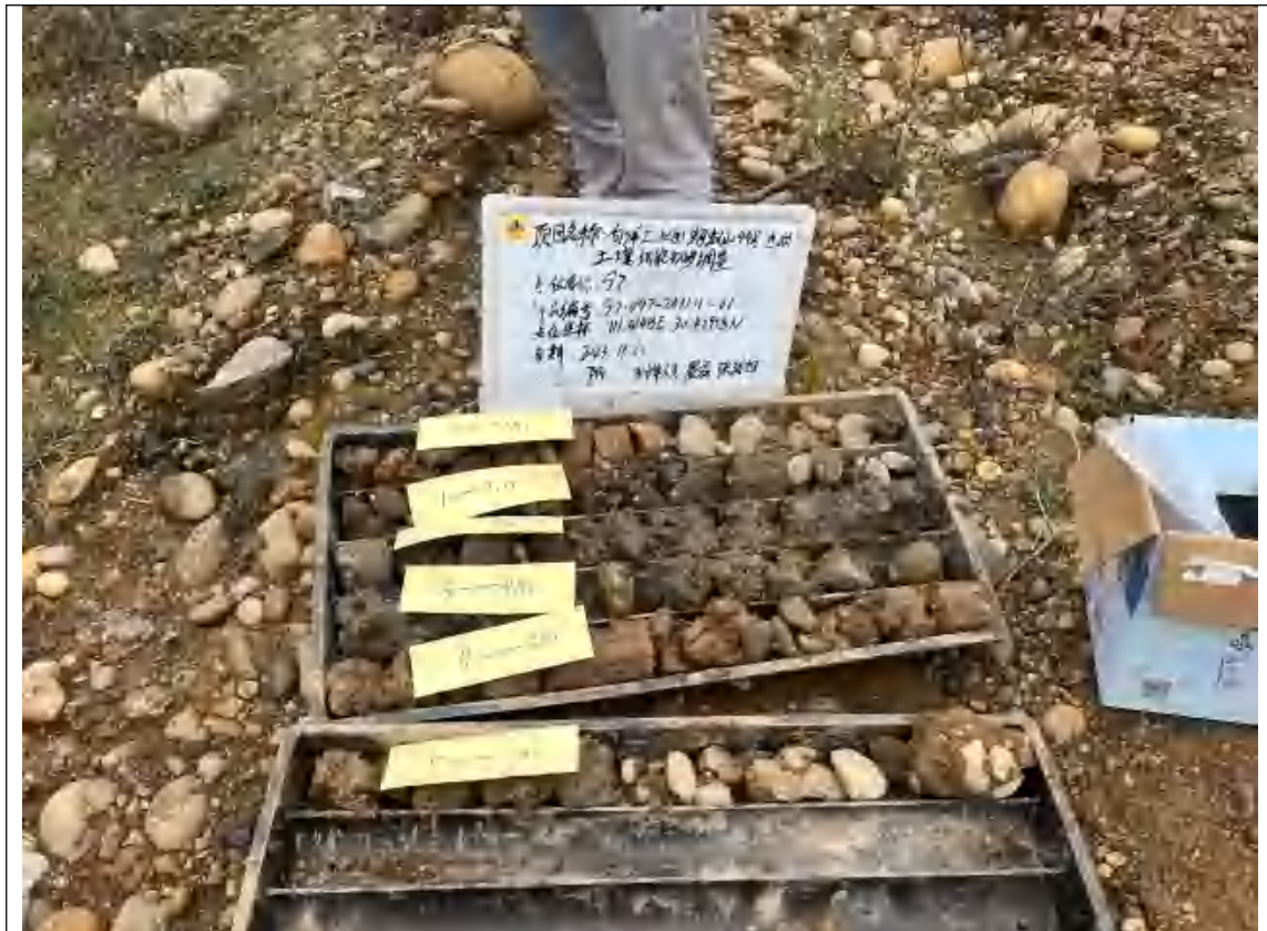
S7 实际土孔钻探深度（6m）
