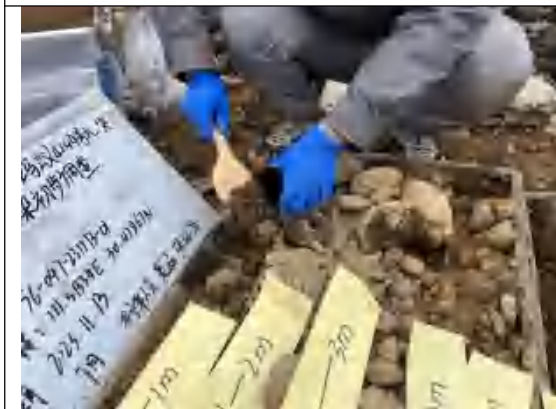
土壤样品 SVOCs 取样
