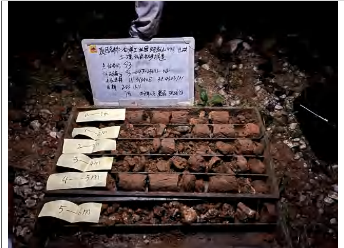
S3 实际土孔钻探深度 (6m)
