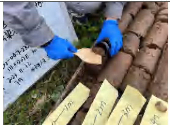
S2 第一层土壤样品 SVOCs 取样装瓶
