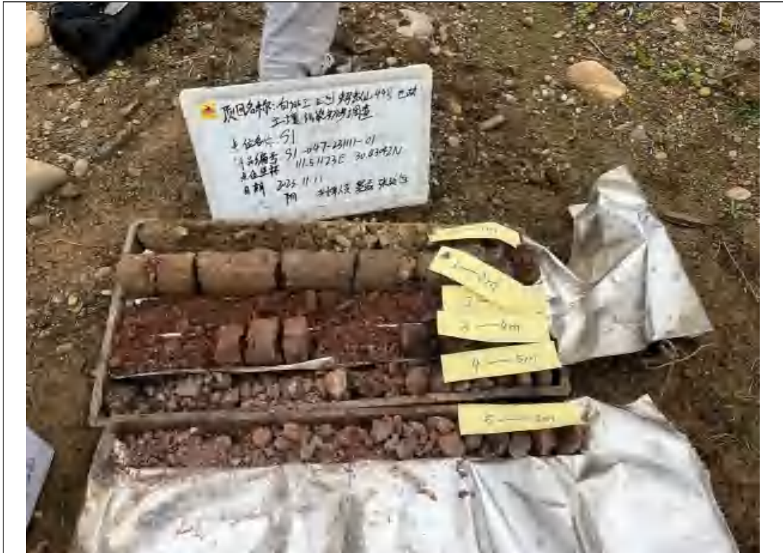
S1 实际土孔钻探深度 (6m)
