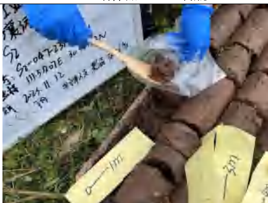
S2 土壤样品重金属取样装袋
