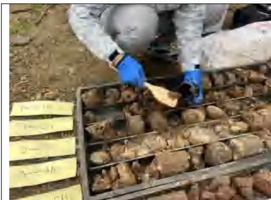
土壤样品 SVOCs 取样
