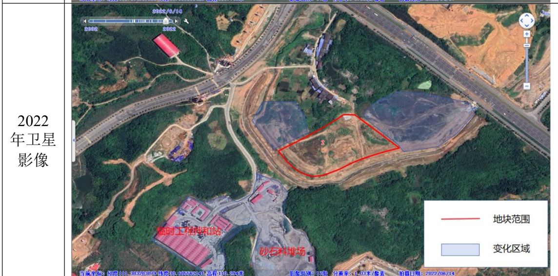
2020年至2022年变化情况: 地块西北侧和东北侧地块平整, 西南侧建设宜兴铁路ZQ-1标段的临时工程拌和站及其砂石料堆场, 周边修建部分道路 注: 红色为地块范围, 蓝色为变化范围
