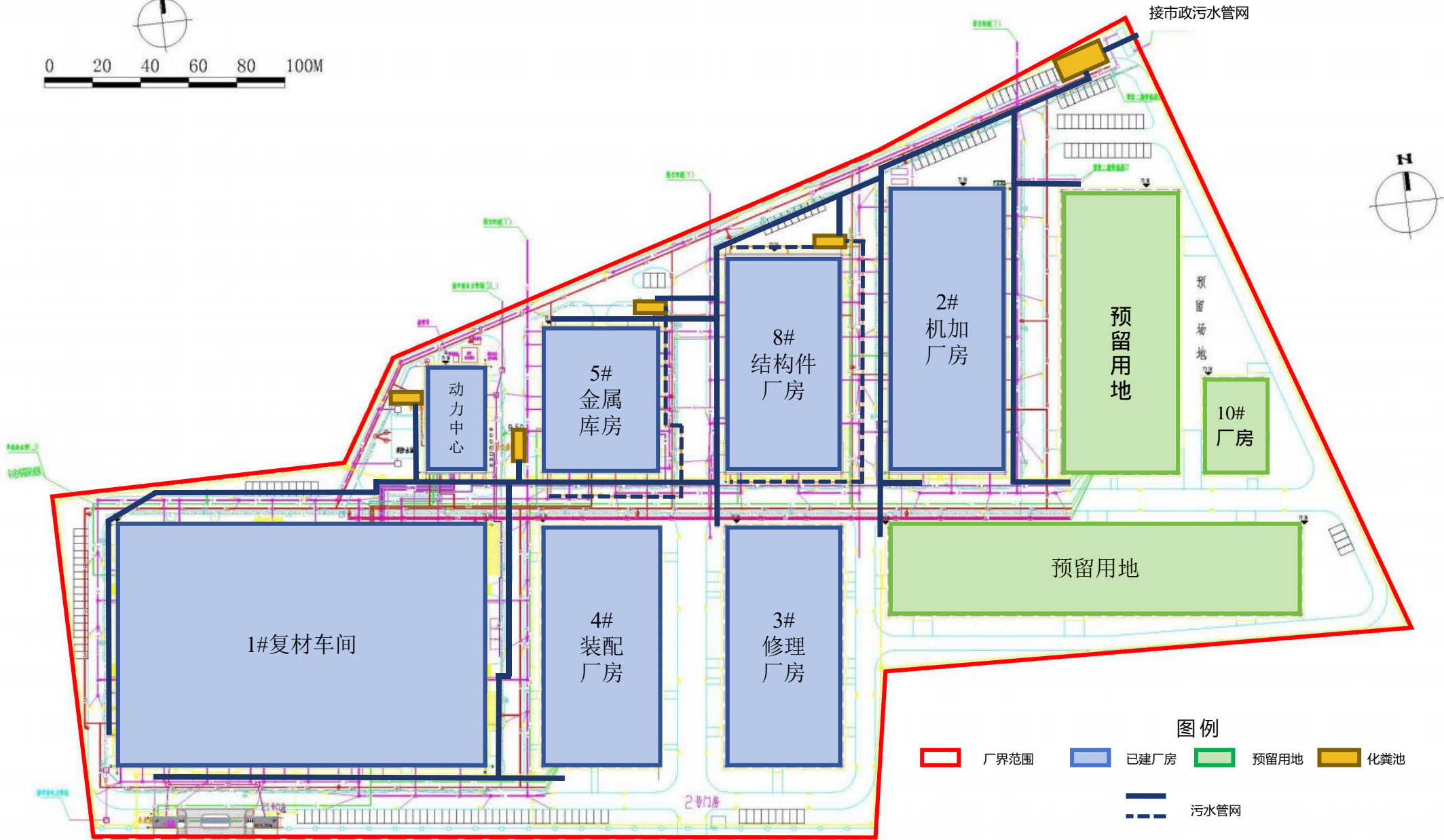
附图4-2 项目污水管网图
