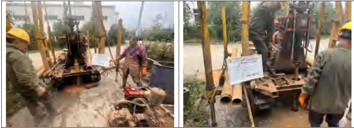
T04 土壤点钻探取芯过程
