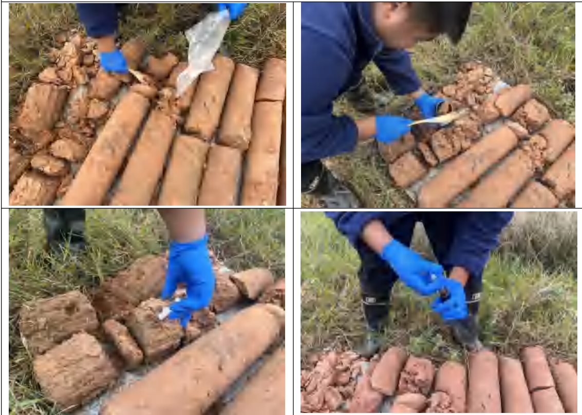
T06 土壤点土芯和采样过程
