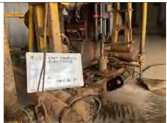
T03 土壤点钻探取芯过程
