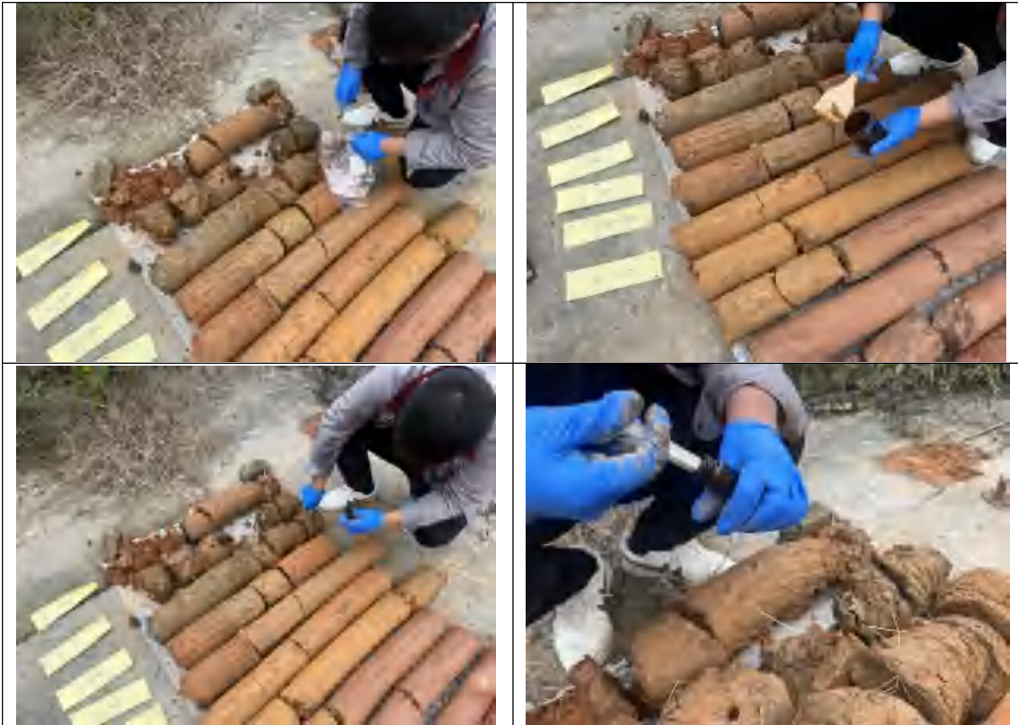
T05 土壤点土芯和采样过程
