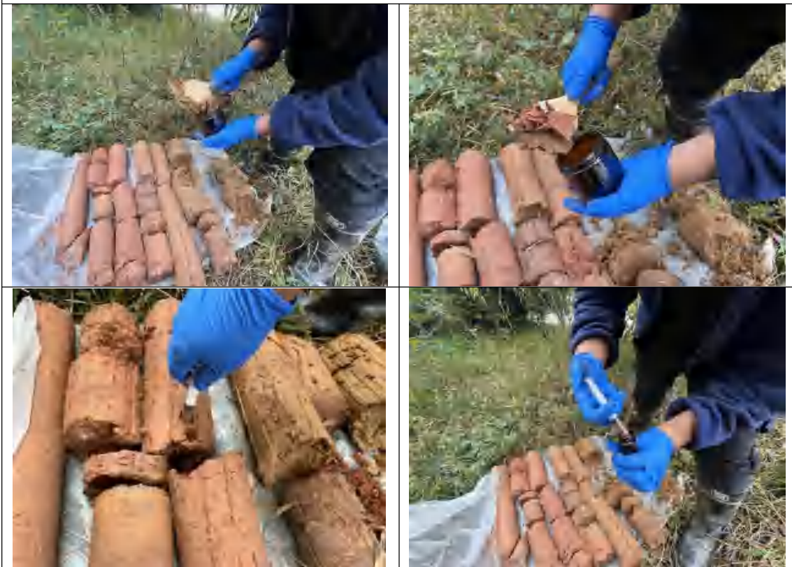
T04 土壤点土芯和采样过程（金属、半挥发、挥发）
