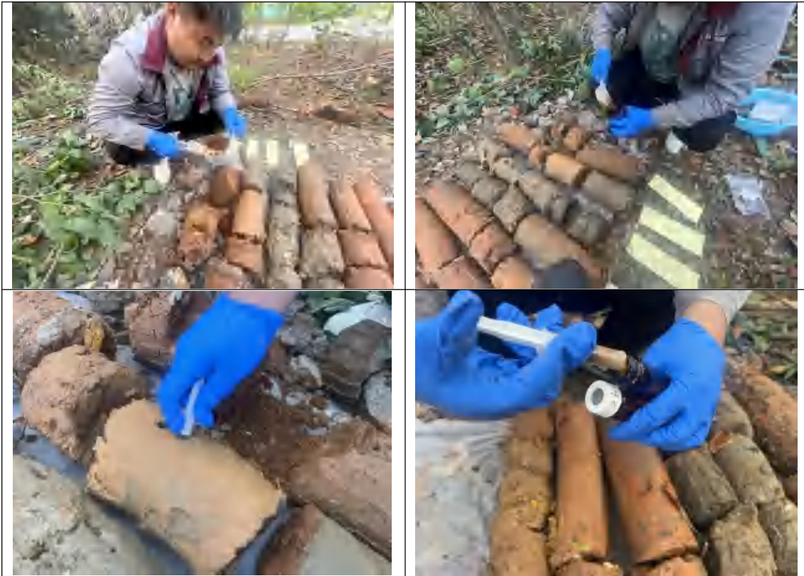
T01 土壤点土芯和采样过程（金属、半挥发、挥发）
