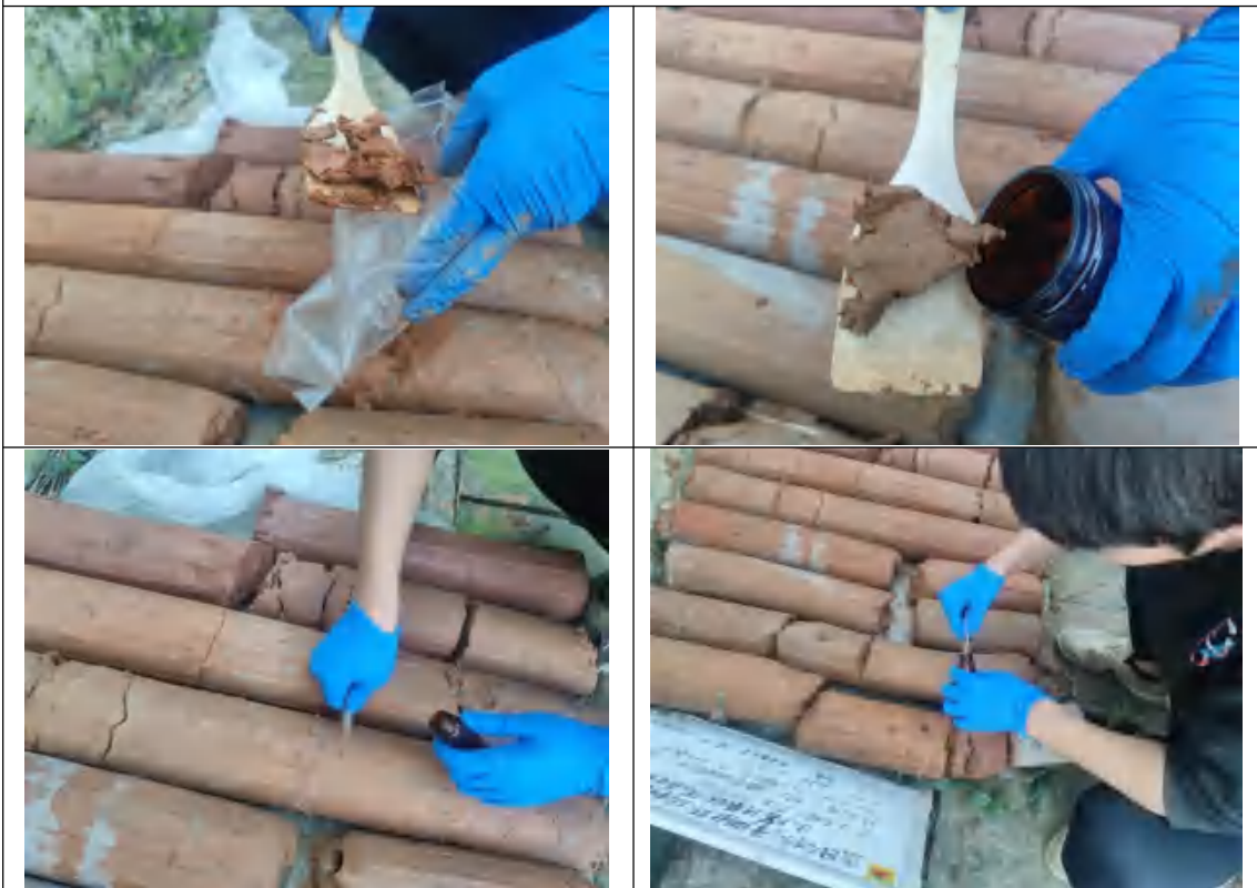
T02 土壤点土芯和采样过程（金属、半挥发、挥发）
