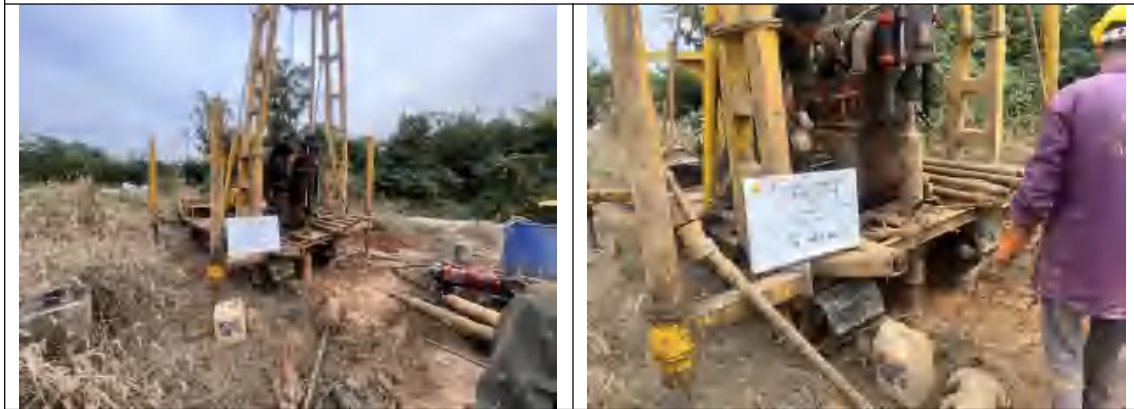
T05 土壤点钻探取芯过程
