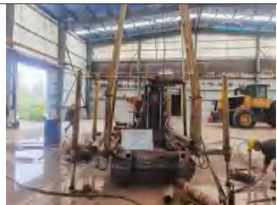
T02 土壤点钻探取芯过程
