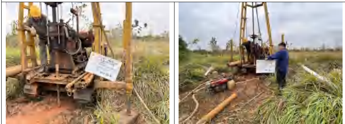
T06 土壤点钻探取芯过程
