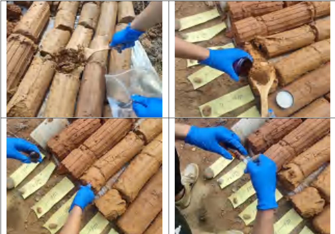
T03 土壤点土芯和采样过程（金属、半挥发、挥发）
