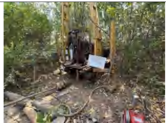
T01 土壤点钻探取芯过程
