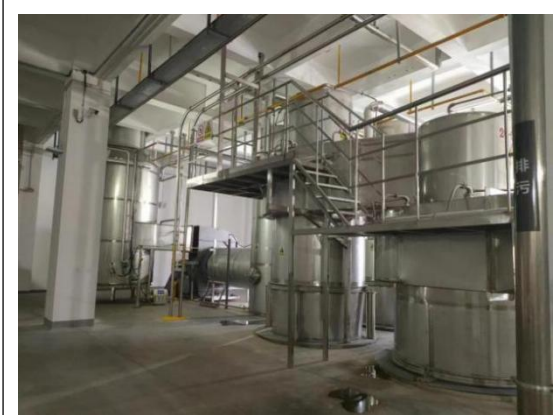
旋风分离器+水膜除尘器+二级水喷淋（喷雾干燥塔-干燥废气）
