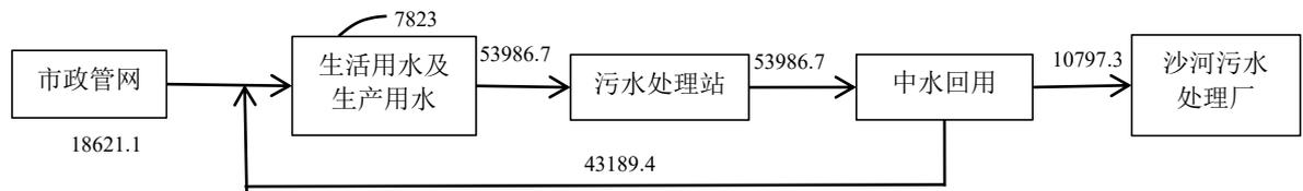
图 2-2 项目满负荷条件下全厂水平衡图
