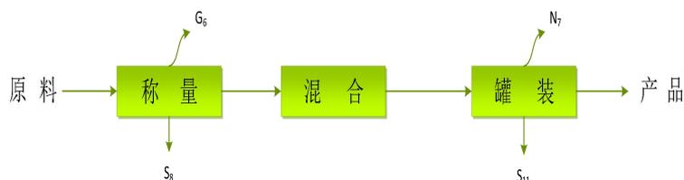
图 2-7 粉类生产工艺流程及产污节点图
