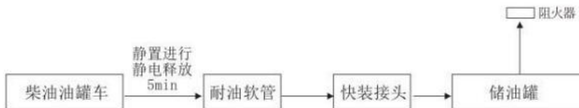
图 2.4-2 柴油卸油工艺流程图
