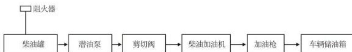
图 2.4-4 柴油加油工艺流程图
