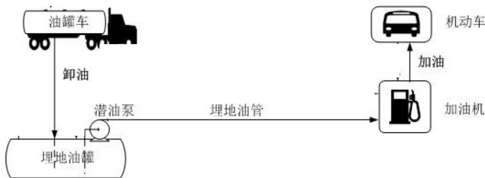
F 图 1.2 加油站柴油工艺流程图
