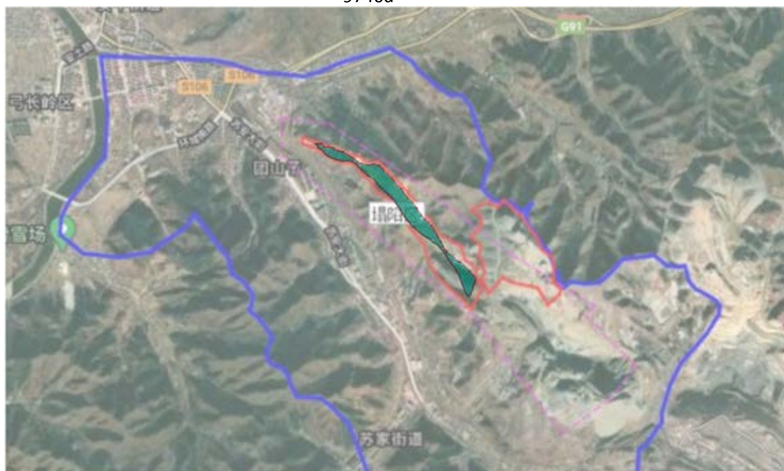
图 7.5-1 回填区淋滤液泄露，Hg 的运移结果图
