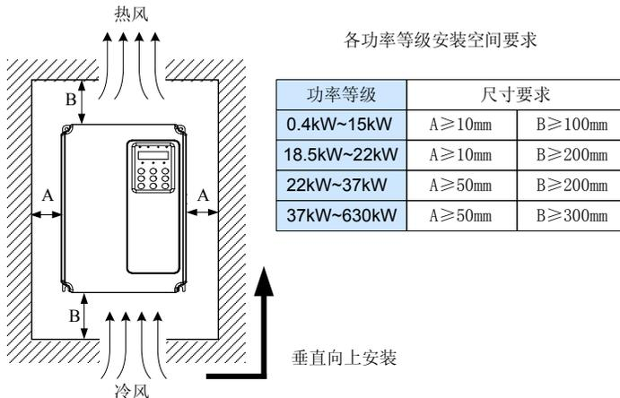
图 3-1 变频器各功率等级安装空间要求
