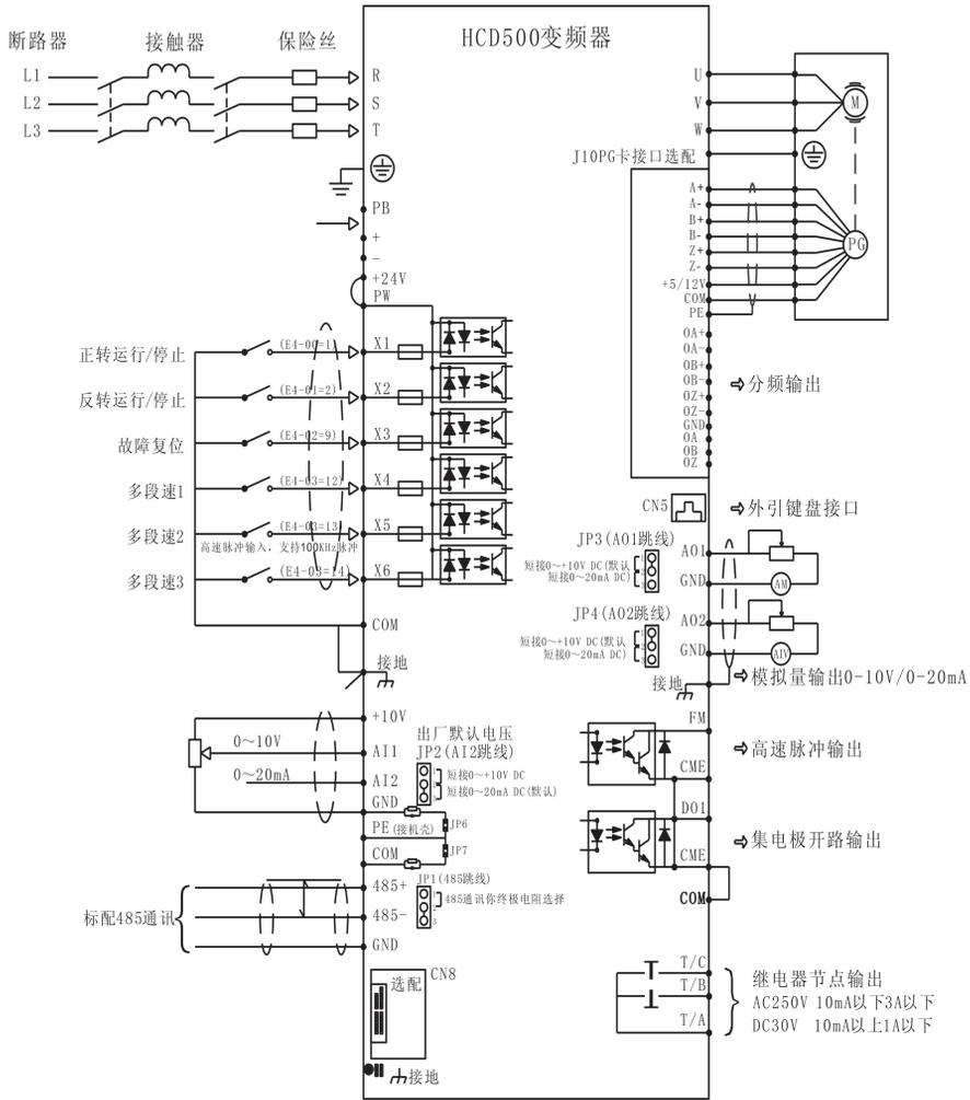
图 3-16 变频器控制回路接线方式
