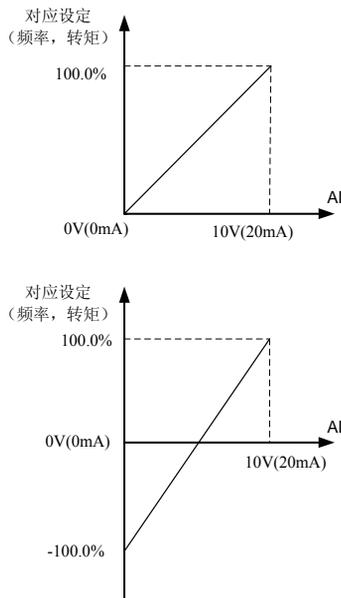
图 6-15 模拟给定与设定量的对应关系
