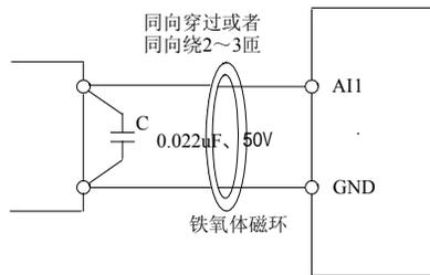
图 3-18 模拟量输入端子处理接线图
