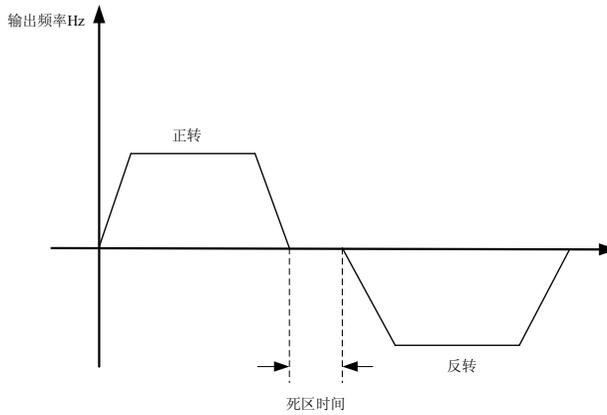
图 6-23 正反转死区时间示意图
