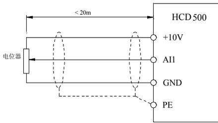
图 3-17 模拟量输入端子接线示意图
