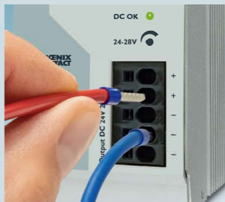
直插式连接技术，轻松实现快速安装，节省时间
