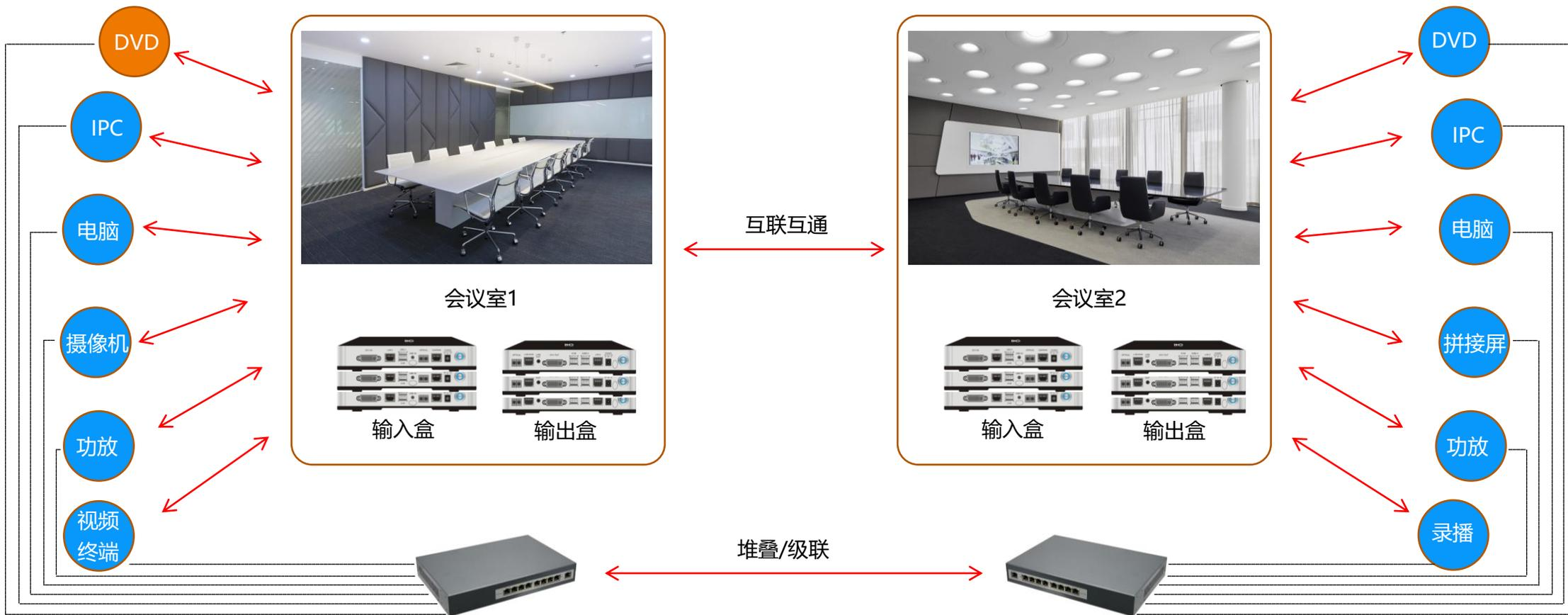
各个会议室都设有输入盒、输出盒多个；根据现场的信号源选择输入盒类型和数量；根据现场的显示设备数量确定输出和的数量。除此之外，在控制中心建设专业扩声、显示屏，集中显示信号、并且能实现信号的管控。各会议室间的输入盒、输出盒信号可以互通、调用。可应用于局域网内部的互动视频会议
