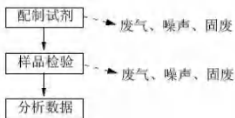
图2-5 分析实验工艺流程及产污节点
