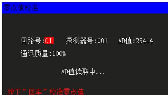
按下“◀ ▶”切换探测器地址，地址切换后自动读取零点 AD 值、显示当前选中探测器的通讯质量
